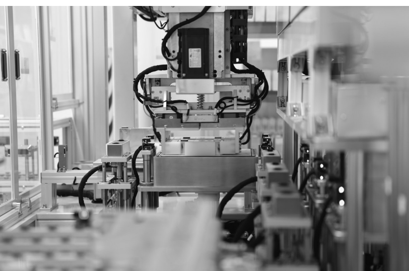
图为山东欣旺达新材料有限公司电芯车间电芯组装工序超声波焊接机进行极耳焊接。
