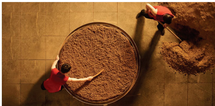
图为二车间工人正在装甑。受访者供图
