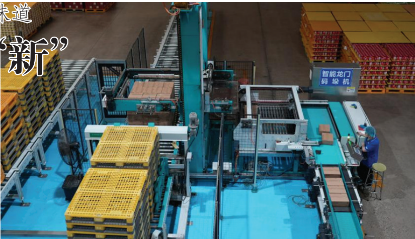
图为米婆婆生产车间智能龙门码垛机作业现场。
