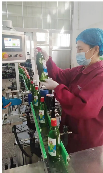
图为工人正在检查贴标机贴的商标是否正确。受访者供图
