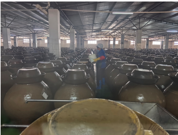
图为玉梦食品麻江明洋食品有限公司二次发酵车间内,工人正在手动添加坛沿水。
