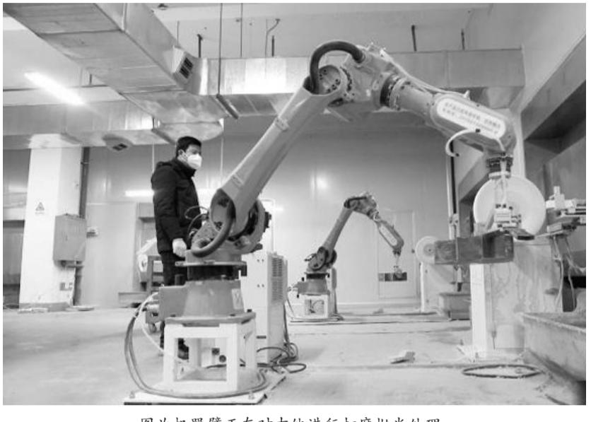
图为机器臂正在对吉他进行打磨抛光处理。
