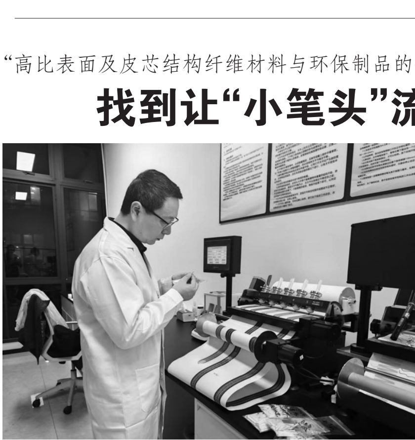
图为王兆伦正在进行纤维笔头划线性能测试。
