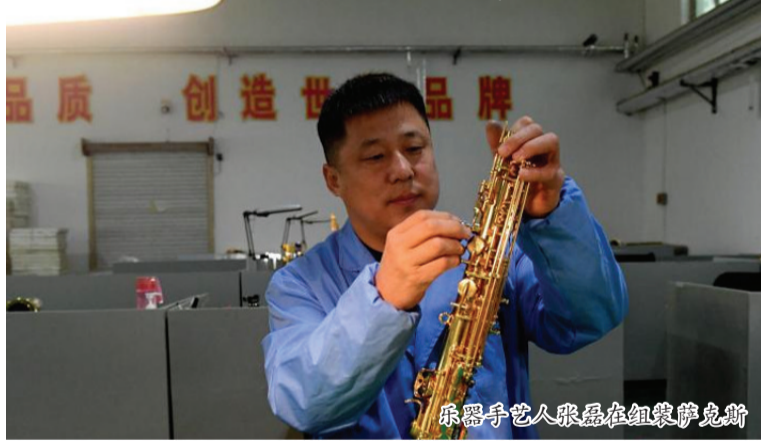
走进河北省衡水市武强县一家乐器企业的组装车间,只见乐器手艺人张磊正在组装萨克斯。一把萨克斯由300余个零件组成,要经过下料、卷筒、焊接等500多道工序才能制作完成。作为中国管弦乐器生产基地,武强县西洋乐器产业起步于20世纪80年代末。目前,该县西洋乐器生产企业达63家,产品涵盖400多种,畅销80多个国家和地区。(中新网)
