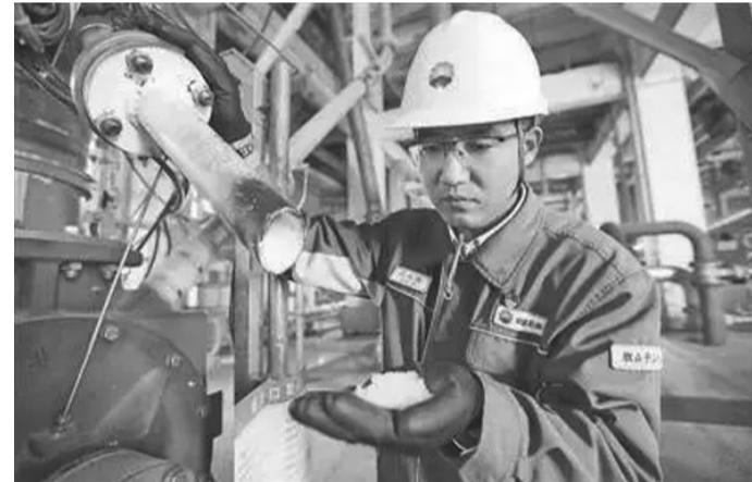
跃。为了抓住销售最佳时机,张永海率领团队成员仅用了3个月就高质量完成了6个月的生产加工任务。在转产过程中,由于新疆冬季气温偏低,茂金属聚烯烃物料流动性较差,取样口常常出现外观酷似“爆米花”的粒状。这些“爆米花”在出料时如果脱水不彻底,极容易造成旋转阀和料仓底部冻结、粒料无法输送。为了减少“爆米花”出现的数量、延长挤压机周期运行的时间,张永海提出人工提前干预的办法。他和几名同事站在狭窄的膜板前,用两天时间,人工疏通了4800个膜孔,提前完成了茂金属的生产加工任务。
