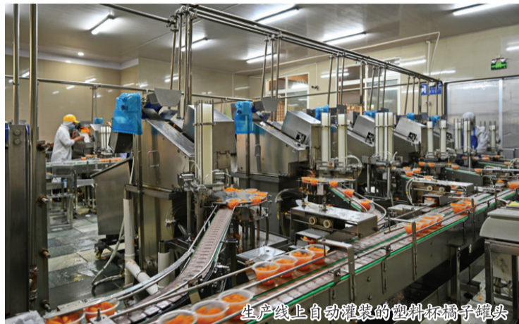
生产线上自动灌装的水果罐头生产线
