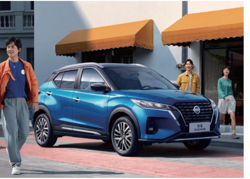
种动力总成。1.5L自然吸气发动机搭配6速手自一体变速器,最大功率为83kW,最大扭矩为145N·m;1.4T涡轮增压发动机搭配7速双离合变速器,最大功率为110kW,最大扭矩为250 N·m。百公里油耗分别是5.9L和5.7L,燃油经济性也不错。涡轮增压与双离合搭配,在动力输出方面和自吸与CVT的搭配感觉还是有所不同,对这方面有偏好的人,相信也不会在乎相对较高的预算。
